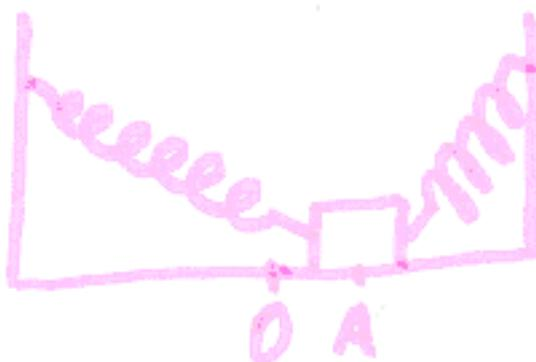
Наличие силы трения покоя приводит к тому, что для приведения тела в движение необходимо воздействовать на него с силой больше максимальной силы трения покоя. На рисунке показан случай, когда на бруск с двух сторон действуют две пружины. При отсутствии силы трения бруск может совершать колебания. При наличии силы трения колебания возможны лишь для достаточно большой амплитуды. При этом это будут затухающие колебания. В конце концов тело остановится в некоторой точке между точками А и Б.
