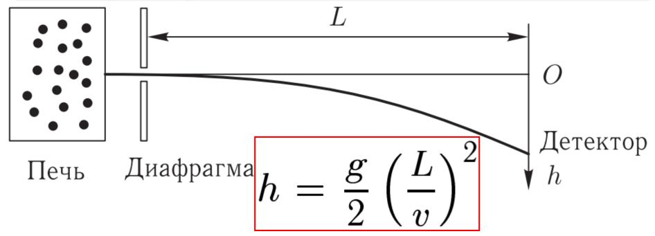
В 1947 г. И. Эстерманом, О. Симпсоном и О. Штерном были выполнены эксперименты по измерению отклонения вниз горизонтальных молекулярных пучков в поле силы тяжести. В эксперименте пучок атомов цезия вылетал через отверстие в печи с некоторой скоростью *v* и, пройдя диафрагму, под действием силы тяжести начинал двигаться по параболе.
