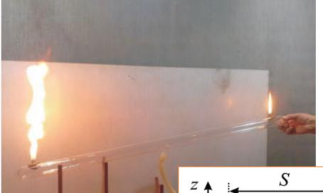
В середине запаянной с обоих концов стеклянной трубки есть боковой патрубок, через который в трубку под давлением несколько большим атмосферного поступает пропан  $C_3H_8$ , имеющий молярную массу 44,1 г/моль.
