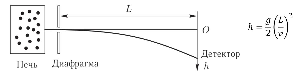
В 1947 г. И. Эстерманом, О. Симпсоном и О. Штерном были выполнены эксперименты по измерению отклонения вниз горизонтальных молекулярных пучков в поле силы тяжести. В эксперименте пучок атомов цезия вылетал через отверстие в печи с некоторой скоростью  $\boldsymbol{v}$  и, пройдя диафрагму, под действием силы тяжести начинал двигаться по параболе.
