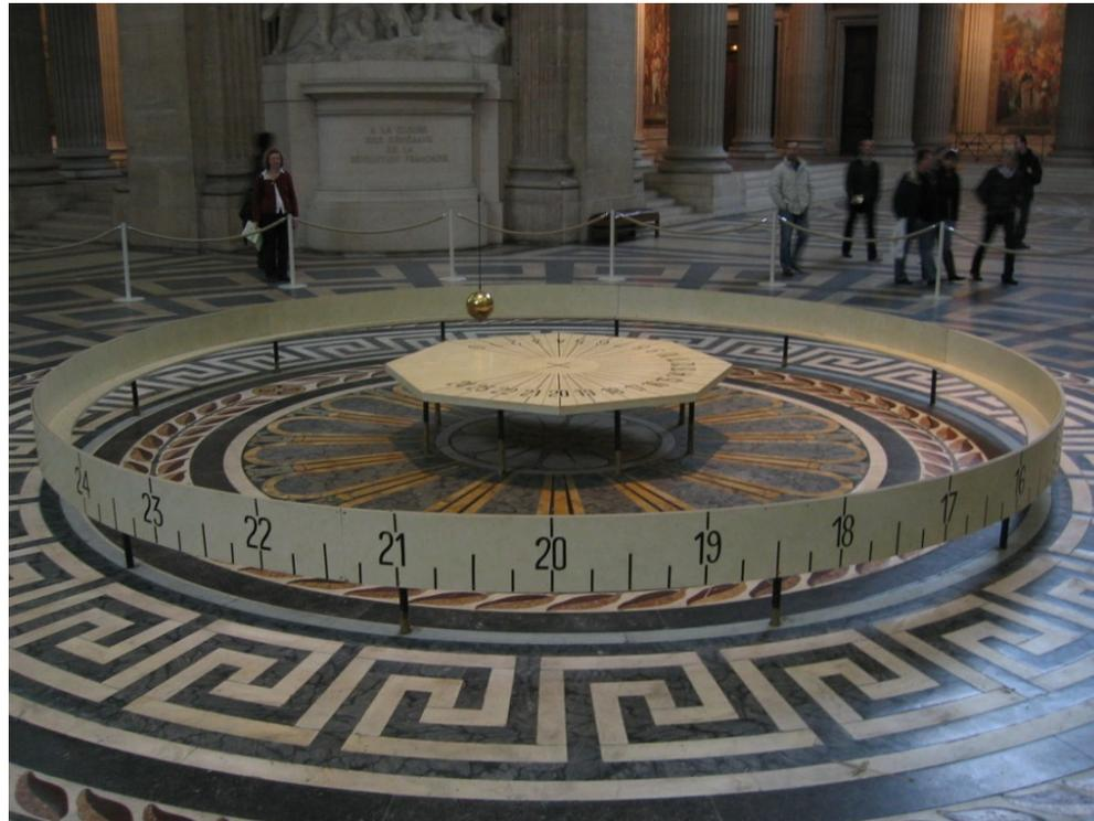
Проекция плоскости колебаний маятника на северный полюс сохраняет положение относительно неподвижных звезд, а Земля поворачивается вокруг своей оси.
