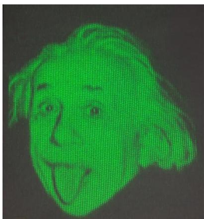
Изображение А. Эйнштейна, сформированное дифракционным оптическим элементом.
