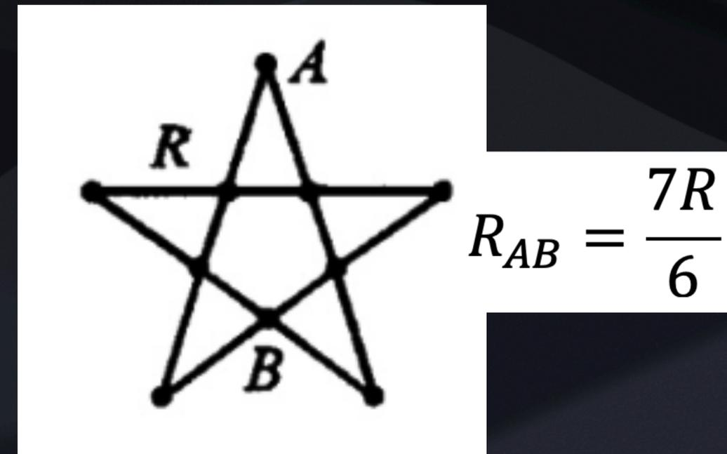
Фигура сварена из кусков проволоки, сопротивление каждого из которых равно  $R = 36 \text{ Ом}$ . Найдите сопротивление между клеммами  $A, B, B'$  и  $B''$ .
