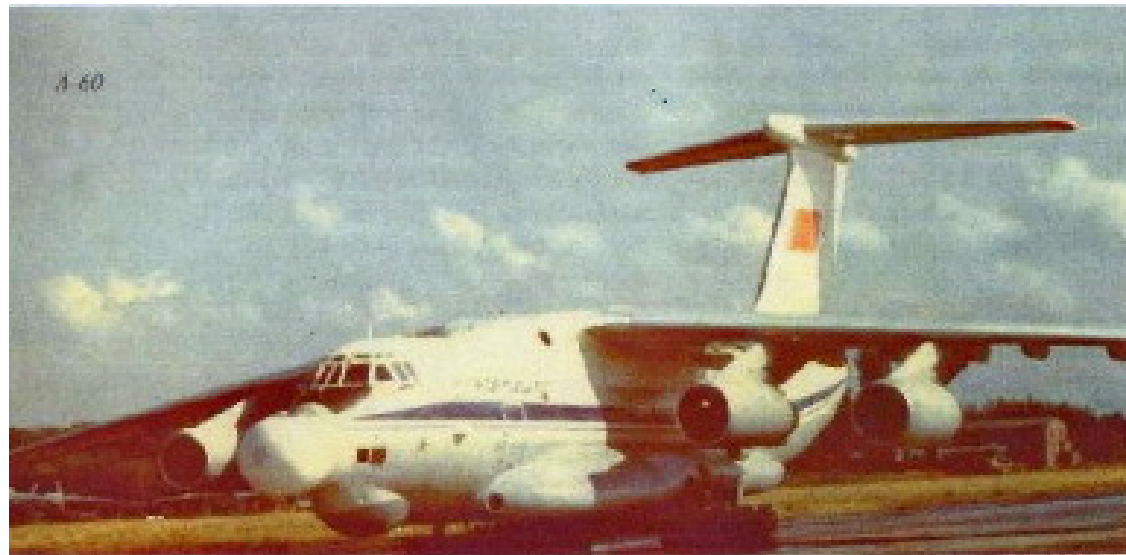
Летающая лаборатория с лазерным оружием на борту класса «воздух-воздух»
