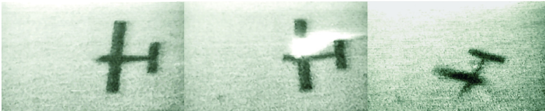
Поражение низколетящей мишени лазерным излучением
