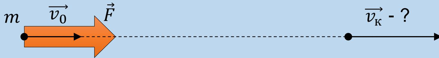
$$\underbrace{F \cdot S}_{\text{Работа силы}} = \frac{mv_K^2}{2} - \frac{mv_0^2}{2}$$
