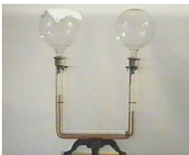
Рис. 5.1. Демонстрация теплоты испарения эфира.
