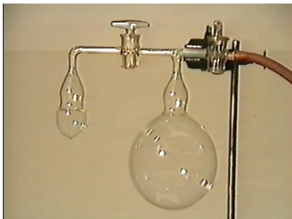
Рис. 6.14. Демонстрация зависимости давления в мыльном пузыре от его радиуса.
