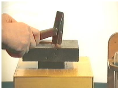
Рис. 8.12. Демонстрация хрупкости резины.
