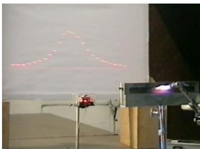
Рис. 8.14. Распределение температуры в стержне.
