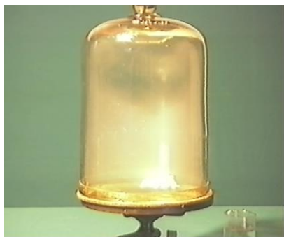
Рис. 5.6. Образование тумана при адиабатическом расширении
