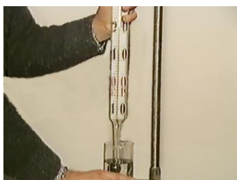
Рис. 1.17. Демонстрация влияния размеров термометра на результат измерения.
