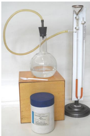
Рис. 7.3. Поглощение теплоты при растворении хлористого аммония в воде.
