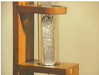
Рис. 5.4. Пленочное и пузырьковое кипение жидкого азота при погружении в него металлической линейки.
