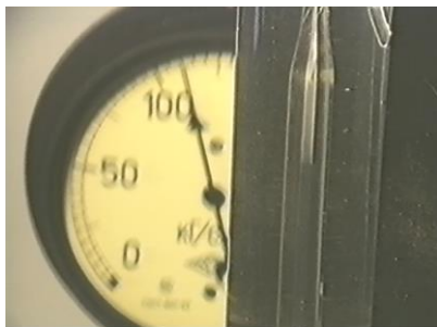
Рис. 5.12. Демонстрация зависимости температуры плавления парафина от давления.
