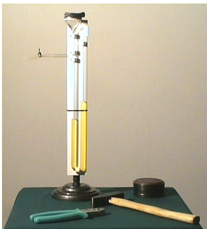
Рис. 3.2. Нагревание свинца после ковки на наковальне.
