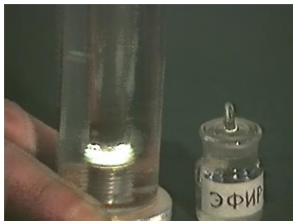
Рис. 3.4. Демонстрация вспышки эфира в воздушном огниве.
