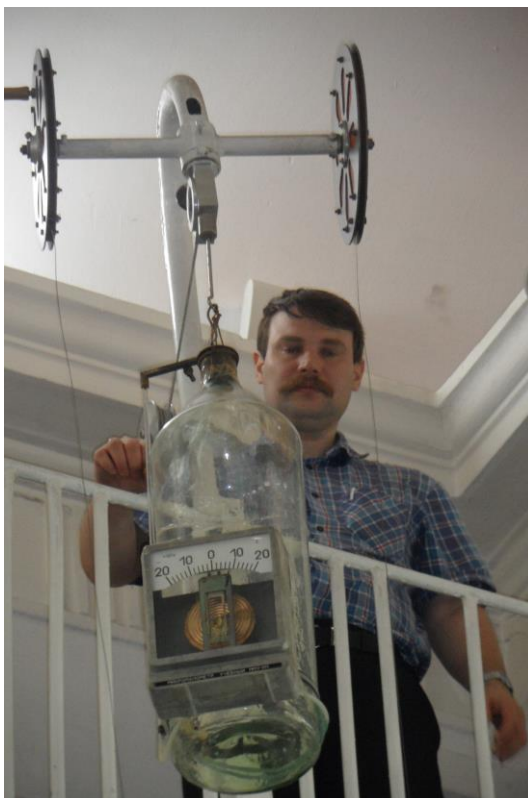
Рис. 1.15б. Бутылка с манометром на уровне балкона аудитории.
