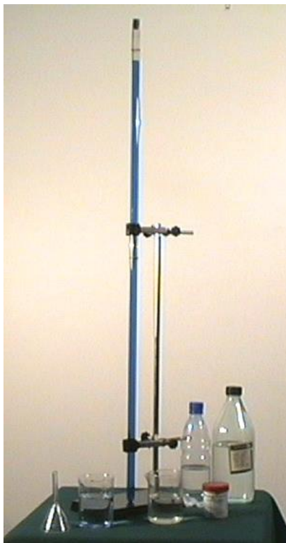
Рис. 7.1. Уменьшение объема при смешивании воды с ацетоном или спиртом.
