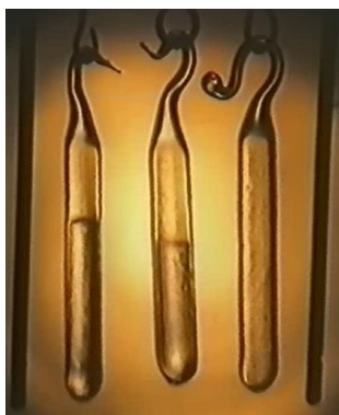
Рис. 4.5. Демонстрация критического состояния эфира.
