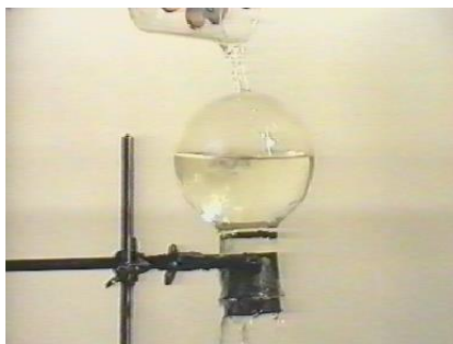
Рис. 5.3. Кипение воды при охлаждении.
