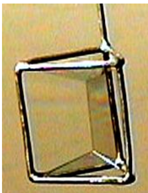
Рис. 6.10. Мыльная пленка на каркасе в виде прямой трехгранной призмы.
