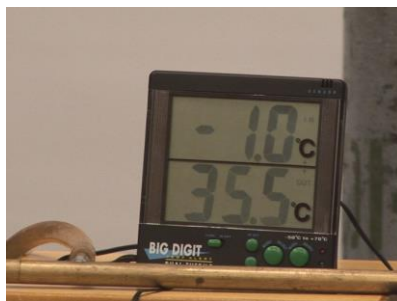
Рис. 3.8. Измерение температуры потоков воздуха на выходе из вихревой трубки.
