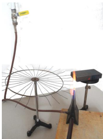
Рис. 3.13. Модель теплового двигателя – колесо с ферромагнитными спицами.
