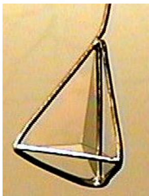
Рис. 6.11. Мыльная пленка на каркасе в виде пирамиды с равносторонним основанием.
