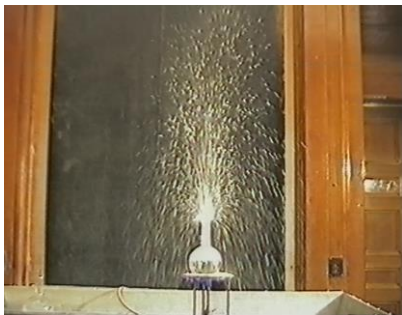
Рис. 5.5. Кипение перегретой воды.
