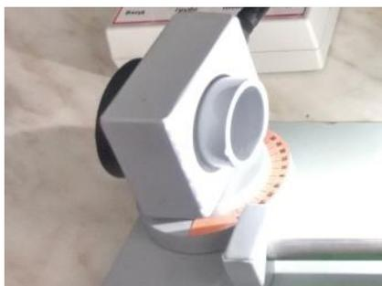
Рис. 7.17. Поворотное устройство солнечной батареи.
