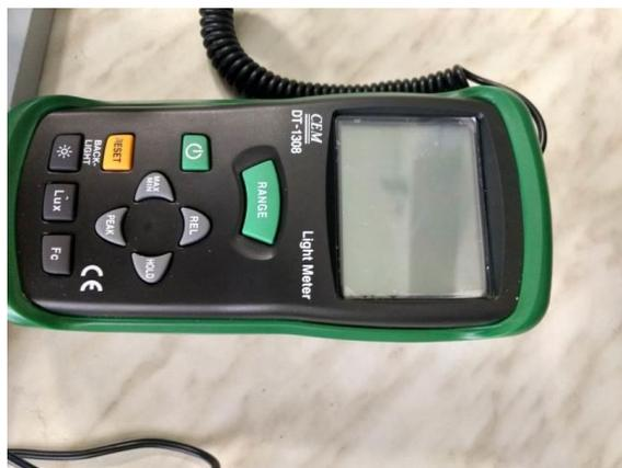
**Погрешность измерений:  $\pm 5\% * X (< 10,000 \text{ Lux})$ ,  $\pm 10\% * X (> 10,000 \text{ Lux})$**
