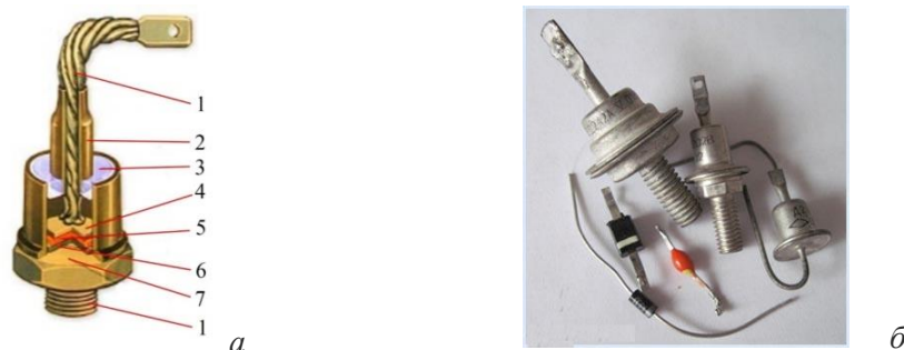
Рис. 7.4. Устройство (а) и внешний вид некоторых типов диодов (б): 1-выводы, 2- корпус, 3- стеклянный изолятор, 4-контактная пластина, 5- пластина индия, 6-пластина кремния (или германия), 7- основание.
