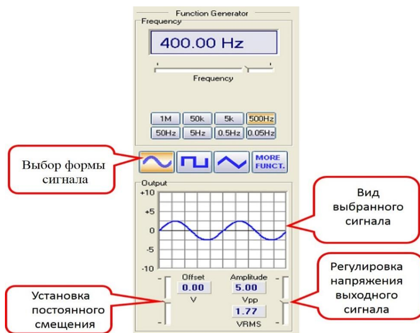
Рис. 4.7. Панель управления работой генератора.
