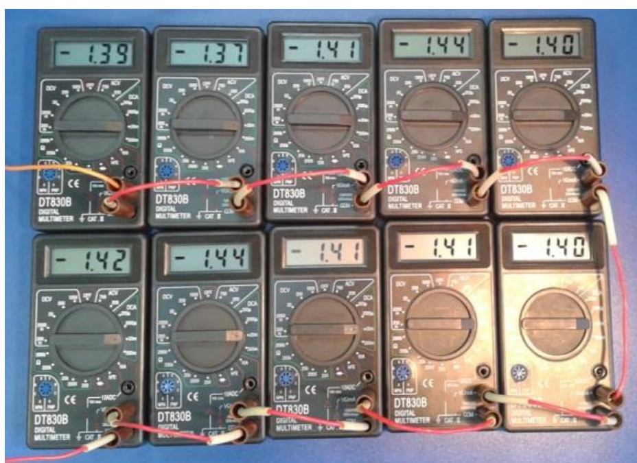
Рис. 3.7. Показания амперметров, соединенных последовательно.
