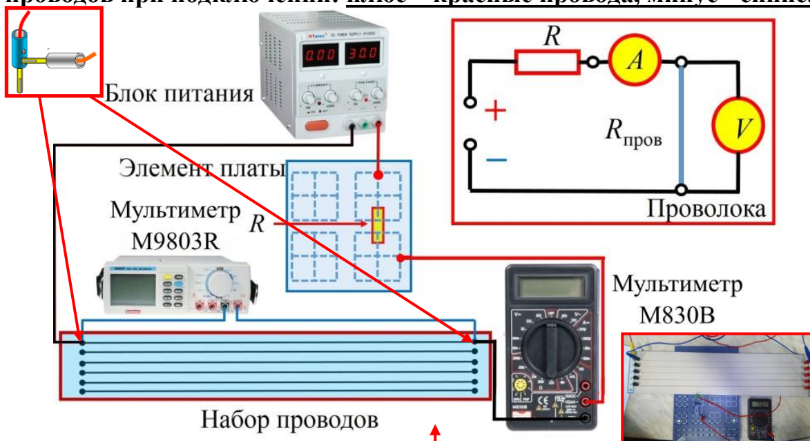
Рис. 3.9. Блок-схема соединения элементов цепи для выполнения упр. 1 . На вставках представлены электрическая схема измерений, общий вид штекера двойного подключения, а также оптимальное расположение элементов схемы.
