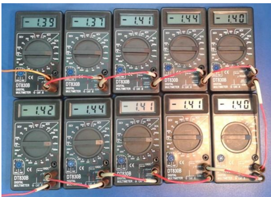
Рис. 3.7. Показания амперметров, соединенных последовательно.
