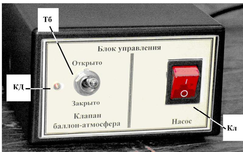
Рис. 5. Элементы управления насосного блока Н
