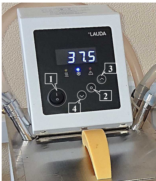
Рис.9 Пульт управления термостатом.
