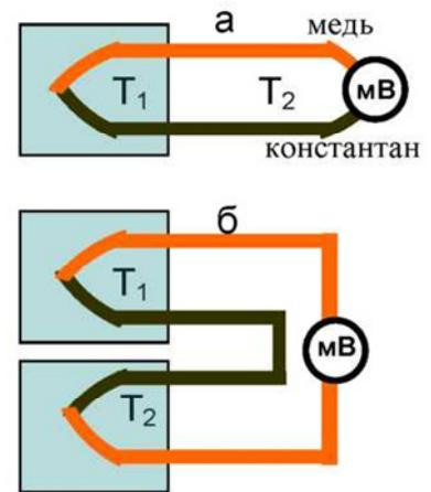
*Рис.2.* Варианты подключения милливольтметра мВ к термопаре
