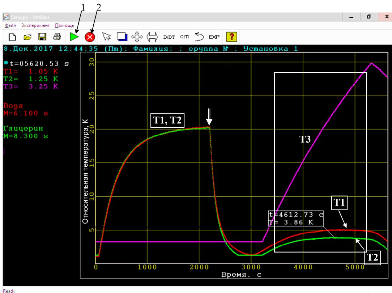
Рис.9 Рабочее поле программы и термограммы T1-T3 за полный цикл измерений
