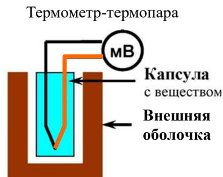
Рис.1 Блок-схема калориметра
