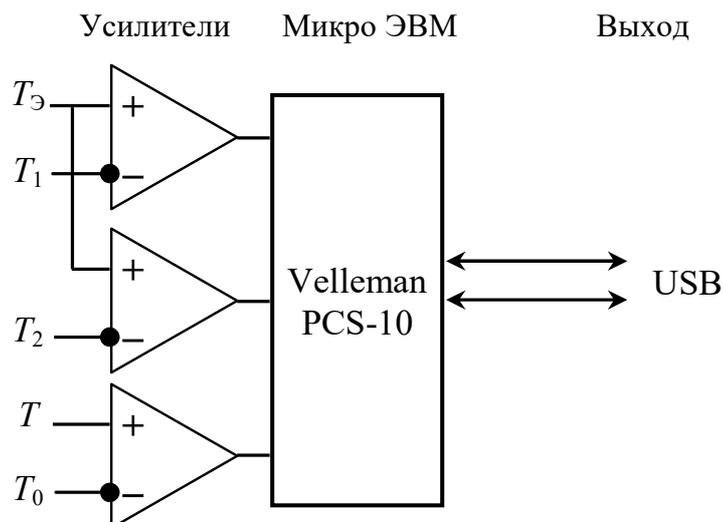
Рис.8. Схема блока сопряжения датчиков температуры с персональным компьютером температура окружающей среды.
