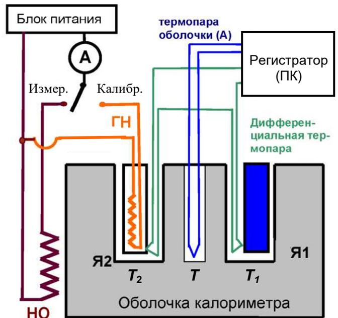
*Рис.3.* Блок-схема установки с дифференциальным калориметром.
