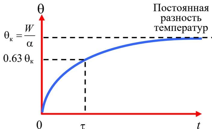
Рис.5. Изменение разности температур эталонной ячейки и оболочки ( $T_{\text{Э}} - T$ ) в процессе ее нагрева при калибровке калориметра
