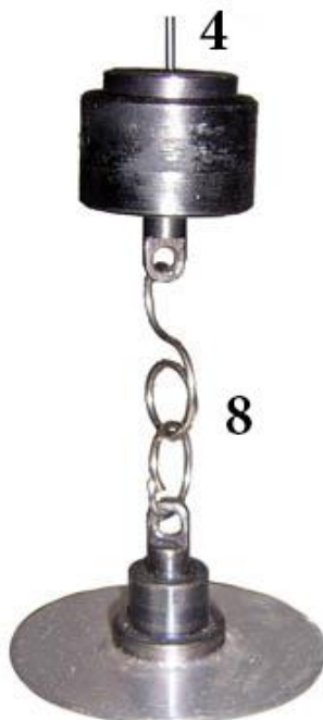
Рис. 7. Соединение нижней насадки стержня с цепочкой. Рис. 8. Установка цепочки 8.
