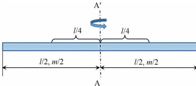
Рис. 2. К определению момента инерции тонкого стержня относительно оси, проходящей через его середину прямой с помощью метода подобия.
