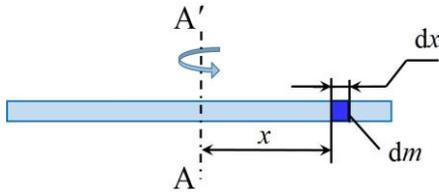
Выделим на нем малый элемент длиной  $dx$  (рис. 1) и массой  $dm = (m/l)dx$ . Если этот элемент находится на расстоянии  $x$  от оси, то его вклад в момент инерции равен  $dJ = x^2 dm$ , т.е.
