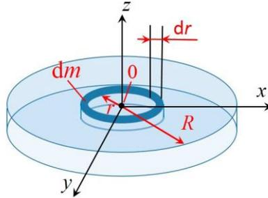
Рис. 3. Выбор системы координат и представление диска в виде набора тонких колец.
