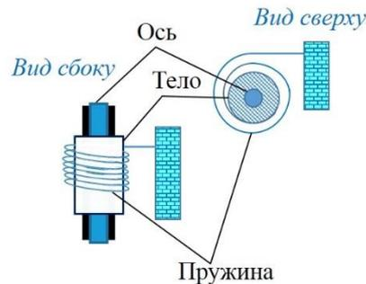
Рис. . Схематическое представление крутильного маятника.
