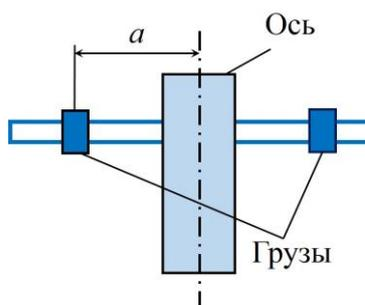
Рис. 4. Положение грузов на стержне крутильного маятника.
