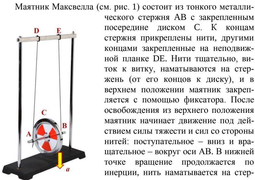
Рис. 1. Принципиальная схема маятника Максвелла.
