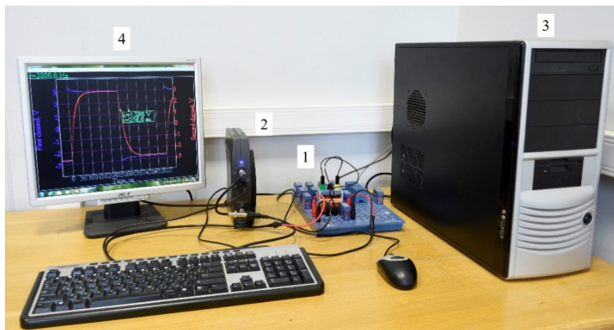
Рис. 2.34. Внешний вид установки: коммутационная плата (1), USB-модуль PClab2000LT (2), компьютер (3), дисплей (4).
