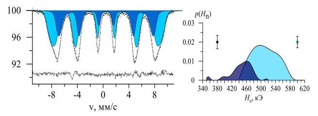
Рисунок 12 Мессбауэровский спектр (слева) контрольного образца СФ при T = 4.2 K во внешнем магнитном поле (B = 6 Тл) и распределение сверхтонкого магнитного поля в области расположения ядра железа (справа) [52].
