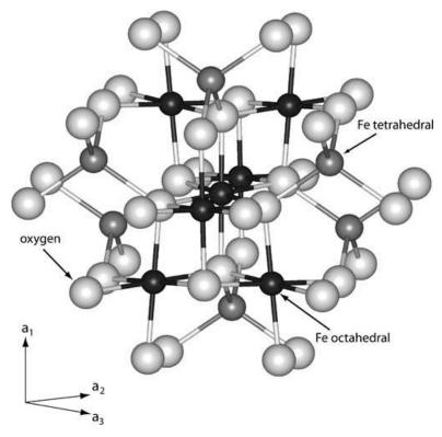
Рисунок 4 Визуализация атомов железа в октаэдрических (черные) и тетраэдрических (темно-серые) позициях и атомов кислорода (светло-серые) в структуре магнетита [46].
