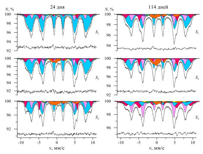
Рисунок 15 Измеренные при T = 4.2 K во внешнем магнитном поле B = 6 Тл мессбауэровские спектры образцов, полученных в результате роста G. ferrihydriticus в течение 24 и 114 дней при различных площадях поверхности ферригидрита, доступных для бактериального восстановления.
