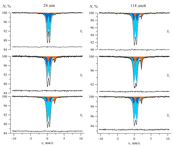
Рисунок 13 Измеренные при комнатной температуре мессбауэровские спектры образцов, полученных в результате роста *G. ferrihydriticus* в течение 24 и 114 дней при различных площадях поверхности ферригидрита, доступных для бактериального восстановления.
