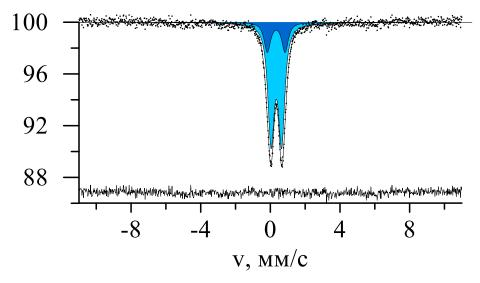
Рисунок 10 Мессбауэровский спектр контрольного образца СФ при T = 300 K.
