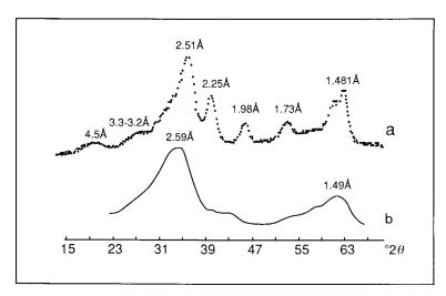
Рисунок 1. Экспериментальные рентгеновские дифрактограммы для а) шестилинейчатого и б) двухлинейчатого ферригидрита. Излучение Си-К  $\alpha$  [32].
