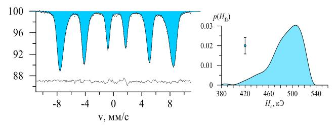
Рисунок 11 Мессбауэровский спектр (слева) контрольного образца СФ при T = 4.2 K и распределение сверхтонкого магнитного поля в области расположения ядра железа (справа) [11].
