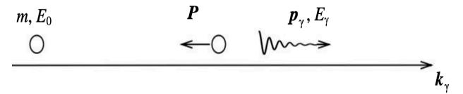
Рисунок 5 Схематическое изображение процесса испускания γ-кванта свободным покоящимся ядром [49].
