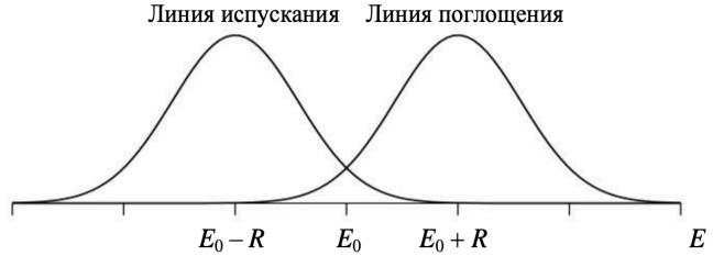
Рисунок 6 Уширенные линии испускания и поглощения γ-квантов свободными движущимеся ядрами [49].
