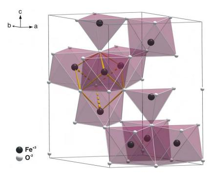
Рисунок 2 Визуализация атомов железа в октаэдрических и тетраэдрических позициях в структуре ферригидрита [38].
