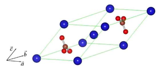
Рисунок 3 Изображение элементарной ячейки сидерита: синий – катионы  $Fe^{2+}$ , красный и рыжий – анионы  $(CO_3)^{2-}$  [42].
