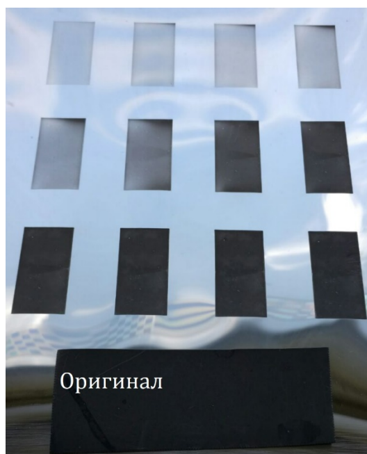
Рис. 2.15. Реплика поверхностного рельефа, выполненная на Ni с разной силой тиснения.
