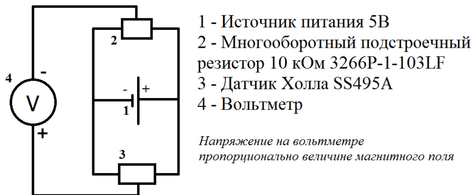
Рис. 1.3. Схема установки для измерения магнитного поля с помощью датчика Холла.
