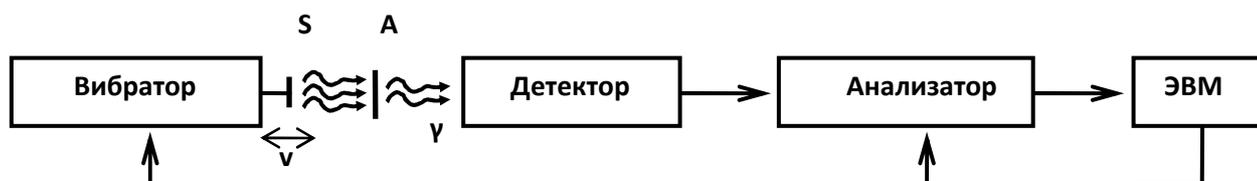
Рисунок 12. Принципиальная схема спектрометра
