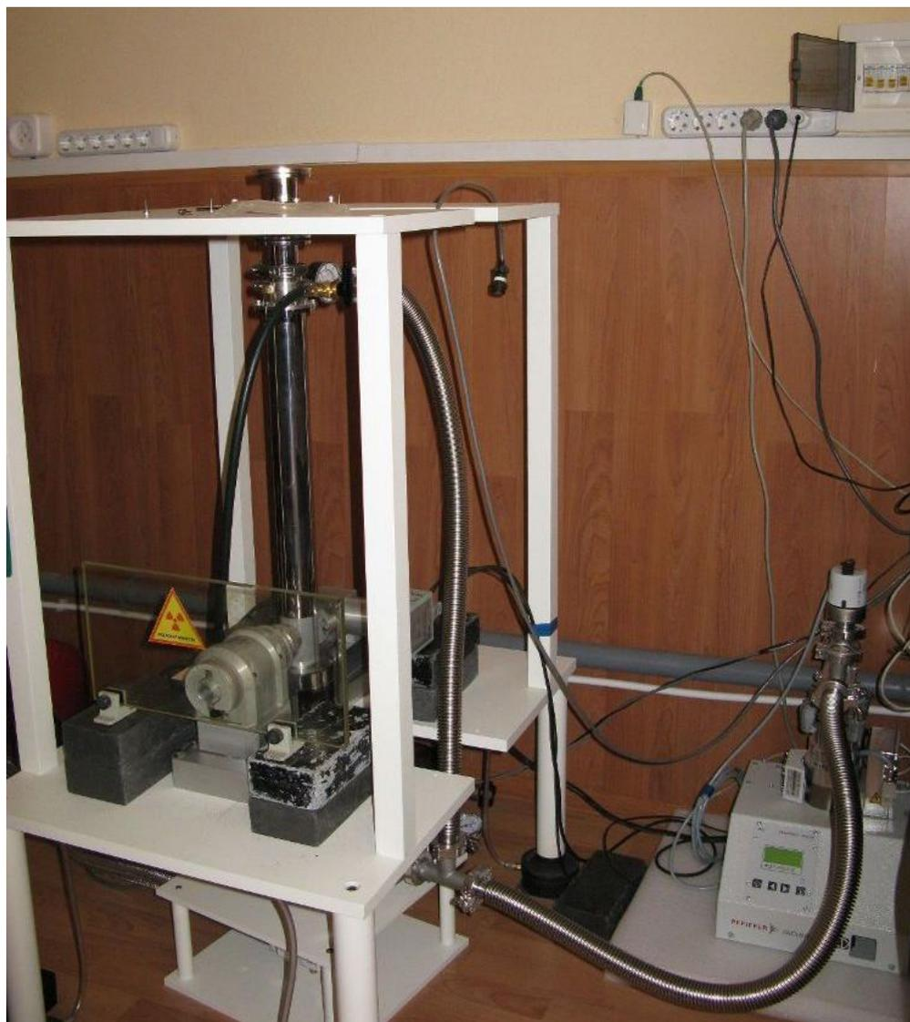
Рис. 10. Фотография гелиевого криостата SHI-850-5 совместно со спектрометром MS-1104Em
