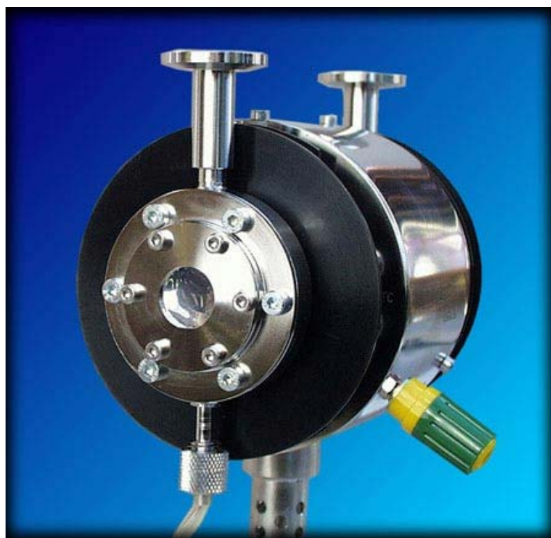
Рис. 2.1. Вакуумная печь для мессбауэровских исследований MBF-1100
