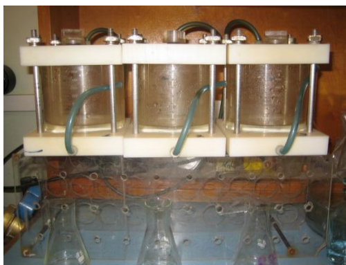
Рис.4. Три ячейки ультрафильтра.
