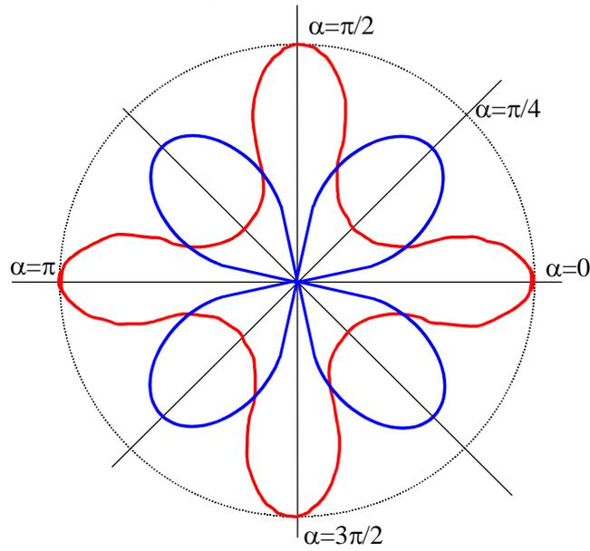
Рис. 2. Интенсивность прошедшего света при скрещенных (синяя кривая) и параллельных (красная кривая) П и А в зависимости от угла  $\alpha$ .
