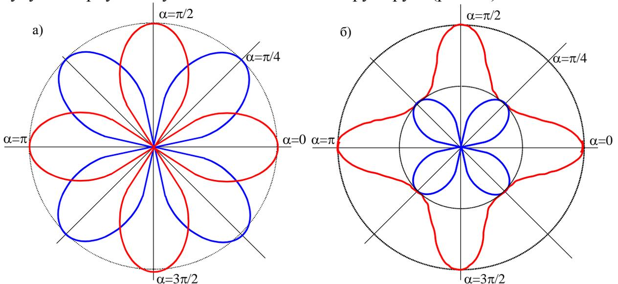
Рис. 3. Интенсивность прошедшего света при скрещенных (синяя кривая) и параллельных (красная кривая) П и А в зависимости от угла  $\alpha$  для пластинок: а)  $\lambda/2$ ; б)  $\lambda/4$ .
