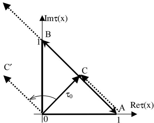
Рис. 6. Расчет комплексных амплитуд для фазового объекта (метод фазового контраста)
