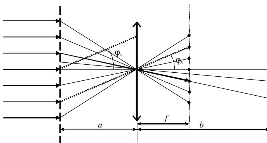
Рис. 1. Схема Аббе-Портера
