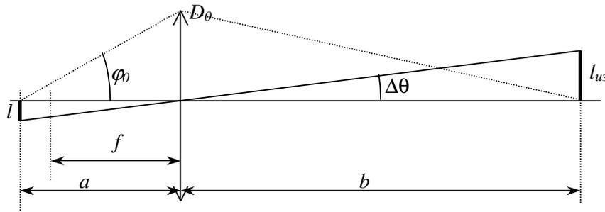
Рис. 6. Формирование изображения в микроскопе
