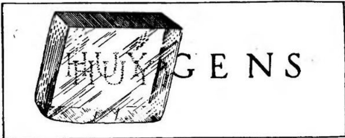
Рис. 2. Два изображения при наблюдении через кристалл исландского шпата.
